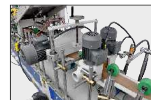
AGREGAT CZYSZCZ CY ZE SZCZOTKAMI GÓRNYMI I BOCZNYMI FRONT, REAR AND TOP BRUSH SYSTEM
