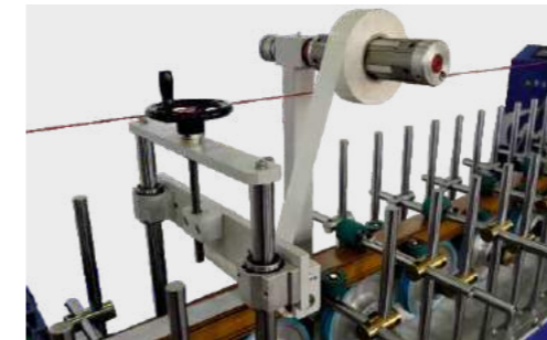
PTA STACJA ODWIJANIA TAŚM Y ZABEZPIECZAJĄCYCH SURFACE PROTECTIVE TAPE LAMINATING STATION
