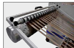
WAŁ NAPINAJ CY Z DYSKAMI CIERNYMI TENSION CONTROLLED FRICTION SHAFT
