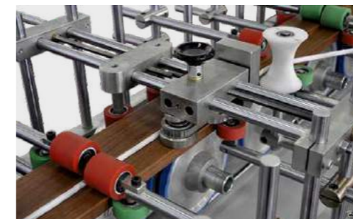
SAU-30 AGREGAT WKŁADAJĄCY USZCZELKĘ SEAL INSERT UNIT
