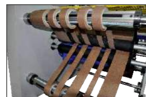
SYSTEM PRZEWIJANIA Z WAŁAMI PNEUMATYCZNYMI TOP-BOTTOM PNEUMATIC FOIL WINDING SHAFTS
