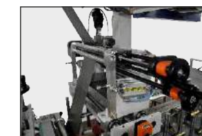
SYSTEM NANOSZENIA TERMOTOPLIWEGO KLEJU POLIURETANOWEGO (PUR) ZA POMOC DYSZY SZCZELINOWEJ POLYURETHANE (PUR) GLUE APPL SYSTEM WITH SL
