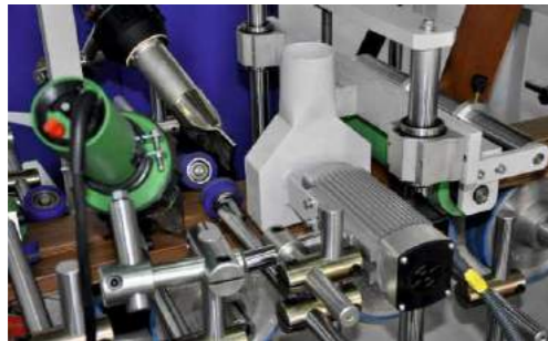
SU AGREGAT PRZYCINANIA KRAWĘDZI EDGE TRIMMING UNIT
