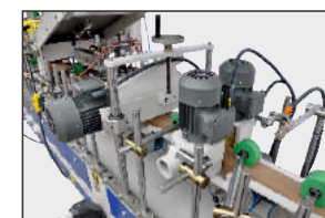
AGREGAT CZYSZCZĄCY ZE SZCZOTKAMI GÓRNYMI I BOCZNYMI FRONT, REAR AND TOP BRUSH SYSTEM
