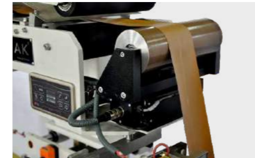
EC-250 JEDNOSTKA POZYCJONOWANIA EDGE CONTROL UNIT
