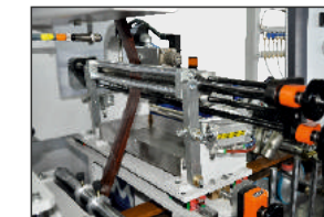
DWUSTRONNY SYSTEM NANOSZENIA TERMOTOPLIWEGO KLEJU POLIURETANOWEGO (PUR) ZA POMOC DYSZY SZCZELINOWEJ PUR GLUE APPLICATION SYSTEM WITH SLOT NOZZLE FOR DOUBLE SURFACES
