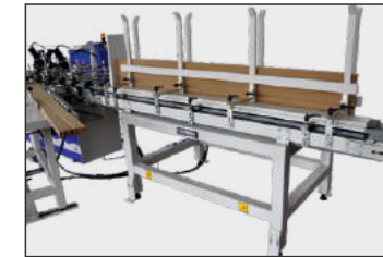
PODAJNIK LISTWY CZOŁOWEJ L CASING BODY FEEDING UNIT
