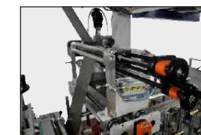
SYSTEM NANOSZENIA TERMOTOPLIWEGO KLEJU POLIURETANOWEGO (PUR) ZA POMOC DYSZY SZCZELINOWEJ POLYURETHANE HOTMELT (PUR) GLUE APPLICATION SYSTEM WITH SLOT NOZZLE
