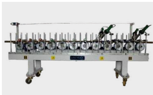
C3-350 3 METRY DODATKOWEGO SYSTEMU KASZETOWEGO DLA STREFY DOCISKOWEJ 3 METER EXTRA CASSETTE (WRAPPING) SYSTEM
